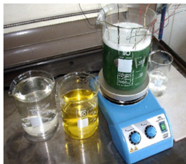
Фиг. 4.12. Никелиране на образци
