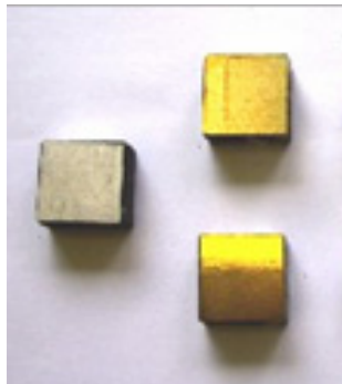
Фиг. 4.13. Безтоково покрити образци
